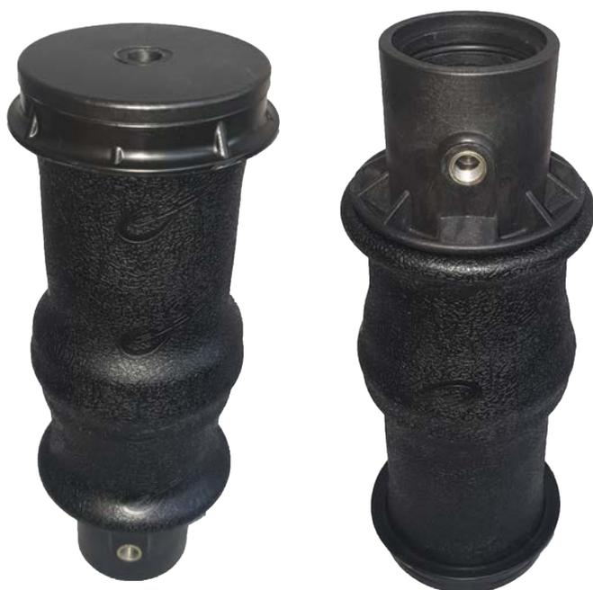
Fuelle neumático de cabina SCANIA
